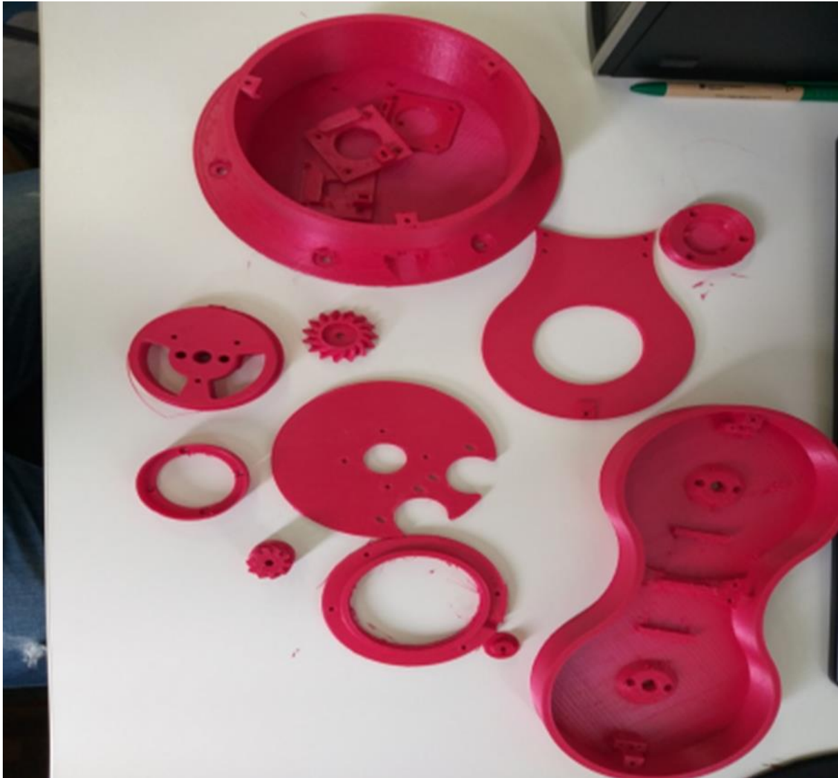
Figura 2 – Peças do braço robótico Thor recém impressas em 3D.
